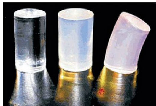
Abbildung 5. Harte und plastische Materialien, die durch Polymerisation unter den gleichen Bedingungen gebildet wurden: reines Polystyrol (links); Gel-Polystyrol, mit 1 Gew.-% DRC (Mitte); Gel-Poly(2-ethylhexylmethacrylat), mit 1 Gew.-% DRC (rechts). Das plastische Material (rechts) wurde vor Aufnahme des Bildes von Hand verformt. [61]
